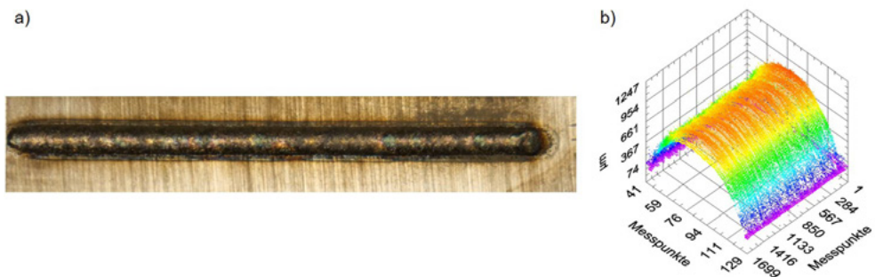
Abb. 3: Mittels Auftragsschweißen erzeugte Schweißnaht (a) und Darstellung der Vermessung der Naht mittels OCT Sensor in einer 3D-Punktewolke (b)
