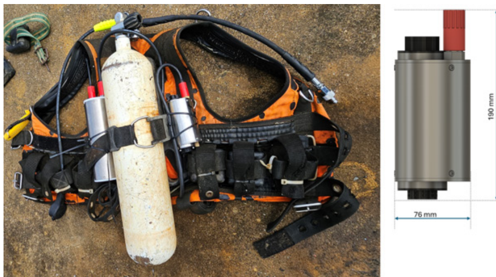
Abb. 2: Taucherkompartiment mit Biosensoren (rechts) und Befestigung am Presslufttauchgerät (PTG) eines Berufstauchers (links).
