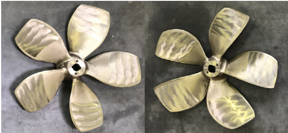
Abb. 2: Fünfflügler mit variiertem Skew, Multipulsion-Konzept
