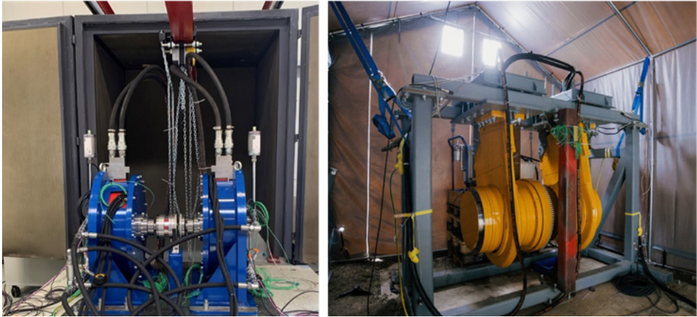
Abb. 7: Aufbau Back-to-Back Prüfstände für Motor- (links) und Getriebetest (rechts)
