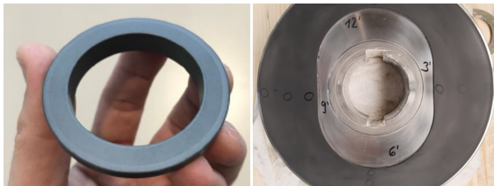
Abb. 3: Gleitring mit einer Diamant-SiC-Intarsie (linkes Bild, matter Bereich); Gleitlager-Spurscheibe mit keramischer Gleitfläche aus einer Diamant-SiC-Intarsie (rechtes Bild)
