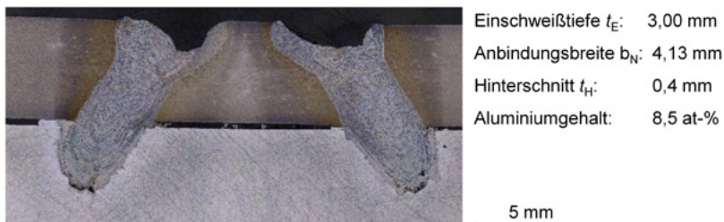
Abb. 8: Querschliff einer Mischverbindung aus dem Stahl S355 und der Aluminiumlegierung EN AW-6082 mit erhöhter Güte
