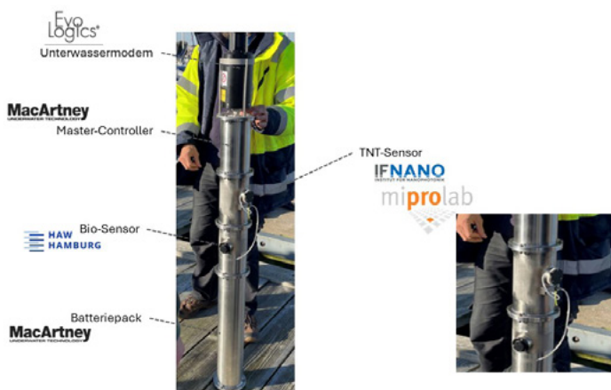
Abb. 1: Aufbau des Geräteträgers inkl. Teilkomponenten der jeweiligen Kooperationspartner
