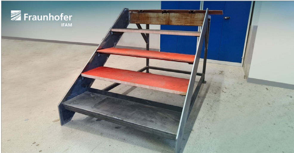
Abb. 7: Demonstrator, mit verschiedenen Stufendesigns: ein Sandwich aus Balsaholz und biobasierten (oberste Stufe) und fossilbasierten Benzoxazin-FVK (zweite Stufe von unten) sowie eine verstärkte monolithische Stufe aus fossilbasierten Polybenzoxazin-FVK (dritte Stufe von unten). Die unterste Stufe ist die Referenz-Stahlstufe. Das Treppenpodest ist ebenfalls eine monolithisch-verstärkte fossile FVK-Platte.
