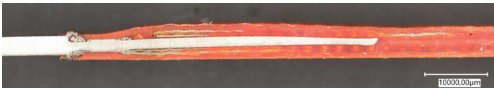
Abb. 3 Querschnitt eines monolithischen FVKs mit integriertem FAUSST-Verbinder.
