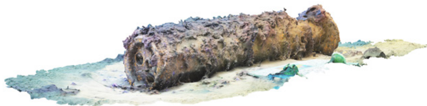
Abb. 2: 3D-Rekonstruktion aus einer Videoaufnahme einer britischen Grundmine aus dem Versenkungsgebiet Kolberger Heide.
