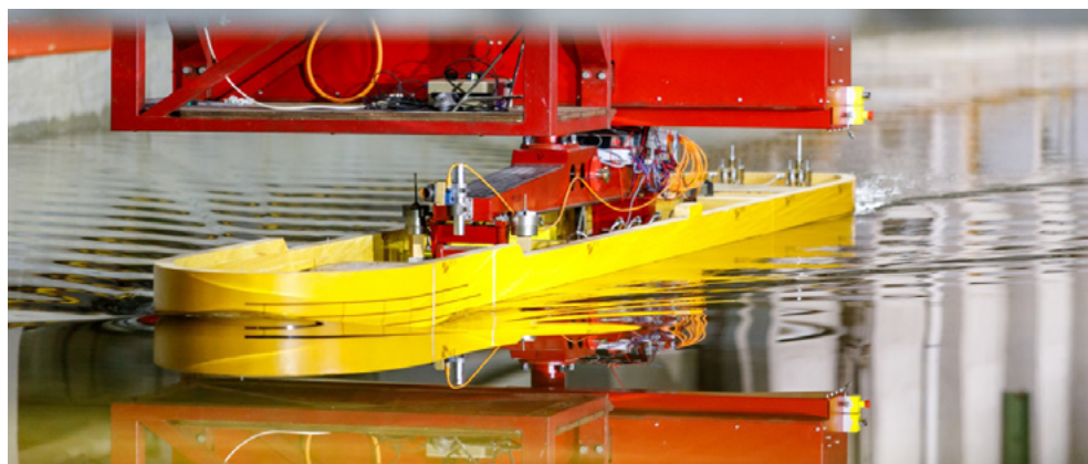
Abb. 9: Schiffmodell an der PMM-Anlage mit einem statischen Driftwinkel
